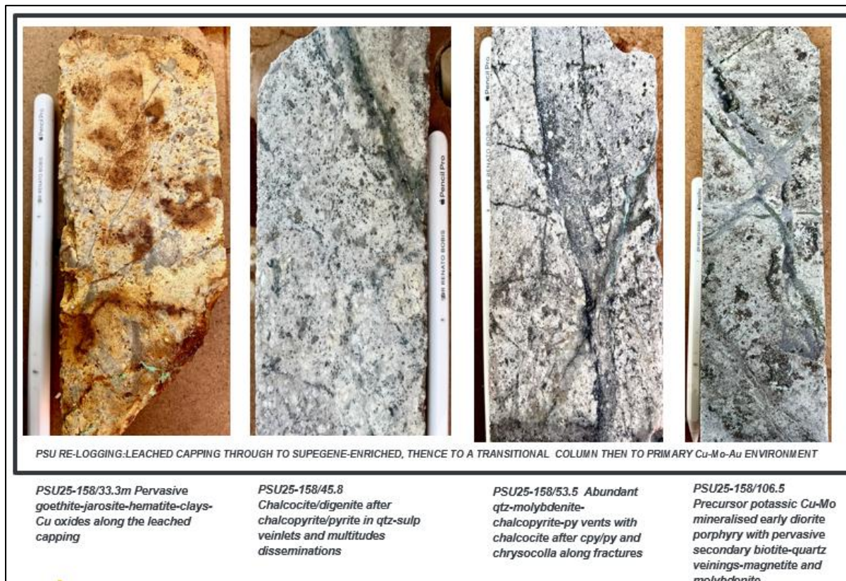
FOTOGRAFÍA 1. Espectro representativo de dominios desde la capa lixiviada superficial hasta el dominio enriquecido supergénico y, a partir de ahí, buzoando hacia abajo hasta un pórfido de diorita con alteración potásica que alberga mineralización de pórfido Cu-Mo-Au.
